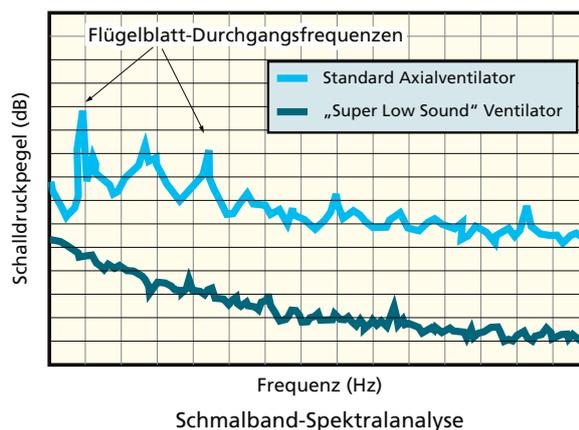
Der „Super Low Sound“-Ventilator senkt den Schallpegel der ATC Verdunstungsverflüssiger und verringert so die Lärmbelastigung!
