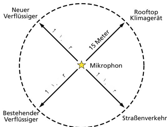
Falls der Schall in einem Abstand von 15 m oder mehr von der schallempfindlichen Stelle festgelegt wird, werden die gemessenen Daten zunehmend ungenauer, da die Wahrscheinlichkeit steigt, dass sich innerhalb dieses Radius von 15 m um das Schallmessmikrophon auch noch andere Schallquellen befinden.
