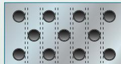
Coil mit runden Rohren Fremdfabrikat
