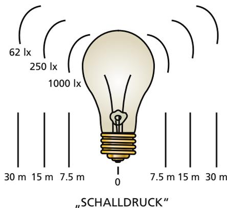
Ähnlich wie bei der von einer Glühlampe ausgehenden Lichtintensität, die geringer wird, je weiter man sich von ihr entfernt, nimmt der Schalldruck in Dezibel mit zunehmender Entfernung von der Schallquelle ab.
