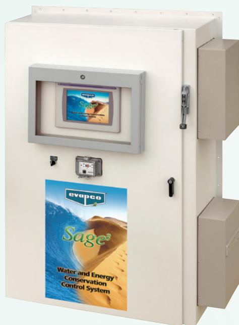
Für den eco-LSWE und eco-LRWB Kühler für geschlossenen Kreislauf bietet EVAPCO optional das Sage2® Regelsystem an. Das System steuert den Betrieb auf eine Weise, die Wasser- oder Energieeinsparung maximiert. Hierfür wird jede Zelle des eco-LSWE und eco-LRWB entweder im Verdunstungsmodus oder im Trockenmodus betrieben, abhängig davon, ob die Priorität auf Wasser- oder Energieeinsparung liegt.
