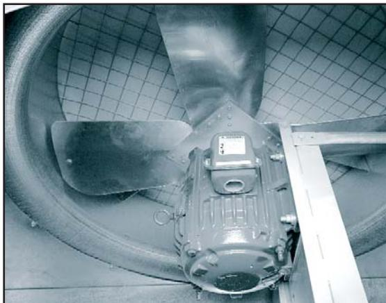
Ventilatorsystem mit Direktantrieb
