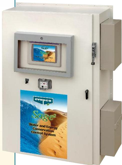
Le refroidisseur à circuit fermé eco-Hybrid est fourni avec le système de contrôle EVAPCO Sage2<sup>®</sup>. Ce système fait fonctionner l'unité de manière à maximiser les économies en eau ou en énergie. Le contrôle s'effectue en faisant fonctionner chaque cellule de l'eco-Hybrid en mode évaporatif ou à sec, en se basant sur la priorité des économies en eau ou en énergie.
