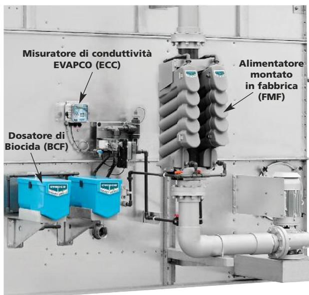
Il sistema **Smart Shield**® EVAPCO utilizza la consolidata tecnologia chimica solida attraverso il nostro rivoluzionario sistema di alimentazione. Ogni volta che la pompa di spruzzamento entra in funzione, il sistema brevettato rilascia automaticamente l'inibitore, mantenendo così sempre protetto il sistema. **Smart Shield**® è un pacchetto completo di trattamento dell'acqua che:
