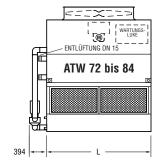
Hinweis: Die Anzahl der Rohrschlangenanschlüsse muss bei den Aggregatetypen ATW 64-3H bis ATW 84-6K verdoppelt werden, wenn die Durchflussmenge 56 l/s übersteigt.
