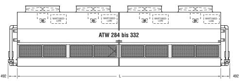
Hinweis: Die Anzahl der Rohrschlangenanschlüsse muss bei den Aggregatetypen ATW 284-3H bis ATW 332-6K verdoppelt werden, wenn die Durchflussmenge 112 Vs übersteigt.
