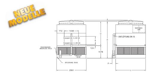
Hinweis: Die Anzahl der Rohrschlangenanschlüsse muss bei den Aggregatetypen ATW 120-3J bis ATW 180-6N verdoppelt werden, wenn die Durchflussmenge 56 l/s übersteigt.
