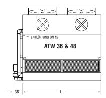
Hinweis: Die Anzahl der Rohrschlangenanschlüsse muss bei den Aggregatetypen ATW 24-3G bis ATW 48-5G verdoppelt werden, wenn die Durchflussmenge 28 l/s übersteigt.
