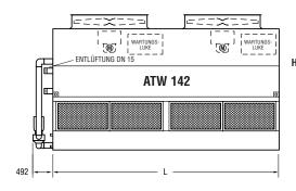
Hinweis: Die Anzahl der Rohrschlangenanschlüsse muss bei den Aggregatetypen ATW 142-3H bis ATW 142-6K ver-doppelt werden, wenn die Durchflussmenge 56 l/s übersteigt.
