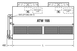
Hinweis: Die Anzahl der Rohrschlangenanschlüsse muss bei den Aggregatetypen ATW 166-3I bis ATW 166-6K verdoppelt werden, wenn die Durchflussmenge 56 l/s übersteigt.
