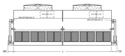
Hinweis: Die Anzahl der Rohrschlangenanschlüsse muss bei den Aggregatetypen ATW 286-3K bis ATW 430-60 verdoppelt werden, wenn die Durchflussmenge 112 l/s übersteigt.
