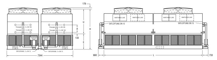
Hinweis: Die Anzahl der Rohrschlangenanschlüsse muss bei den Aggregatetypen ATW 578-3K bis ATW 866-60 verdoppelt werden, wenn die Durchflussmenge 224 l/s übersteigt.
