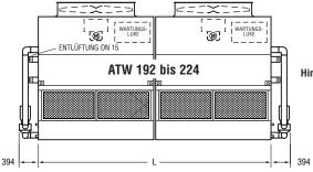
Hinweis: Die Anzahl der Rohrschlangenanschlüsse muss bei den Aggregatetypen ATW 192-3I bis ATW 224-6M verdoppelt werden, wenn die Durchflussmenge 112 I/s über-
