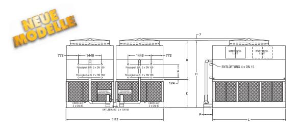
Hinweis: Die Anzahl der Rohrschlangenanschlüsse muss bei den Aggregatetypen ATW 242-3J bis ATW 242-6M und ATW 362-3J bis ATW 362-6N verdoppelt werden, wenn die Durchflussmenge 112 l/s übersteigt.
