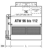
Hinweis: Die Anzahl der Rohrschlangenanschlüsse muss bei den Aggregatetypen ATW 96-31 bis ATW 112-6M verdoppelt werden, wenn die Durchflussmenge 56 l/s übersteigt.
