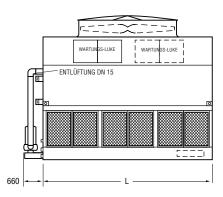
Hinweis: Die Anzahl der Rohrschlangenanschlüsse muss bei den Aggregatetypen ATW 290-3K bis ATW 434-60 verdoppelt werden, wenn die Durchflussmenge 112 l/s übersteigt.
