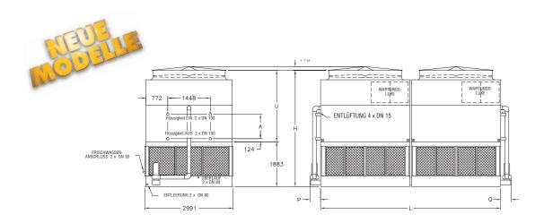
Hinweis: Die Anzahl der Rohrschlangenanschlüsse muss bei den Aggregatetypen ATW 241-3J bis ATW 241-6M und ATW 360-3J bis ATW 360-6N verdoppelt werden, wenn die Durchflussmenge 112 l/s übersteigt.
