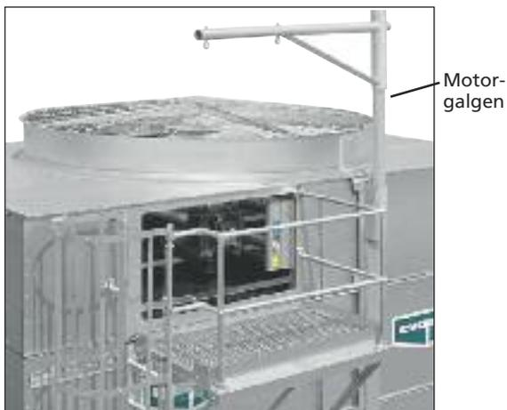
Der Motorgalgen ist eine wirtschaftliche Option. Der Galgen ersetzt einen Kran, falls ein Ventilatormotor ausgetauscht werden muss. Der Service-Monteur braucht nur einen Kettenzug oder eine Seilwinde zum einfachen Entfernen dieser schweren Teile. Der aus stabilem, feuerverzinktem Stahl gefertigte Motorgalgen kann einfach vor Ort montiert werden.
