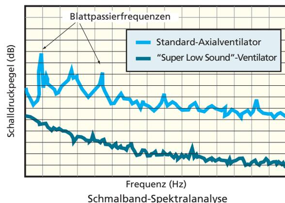
*Der "Super Low Sound"-Ventilator senkt den Geräuschpegel der ATC-DC Hybrid Verdunstungsverflüssiger und verringert so die Lärmbelastung!*
