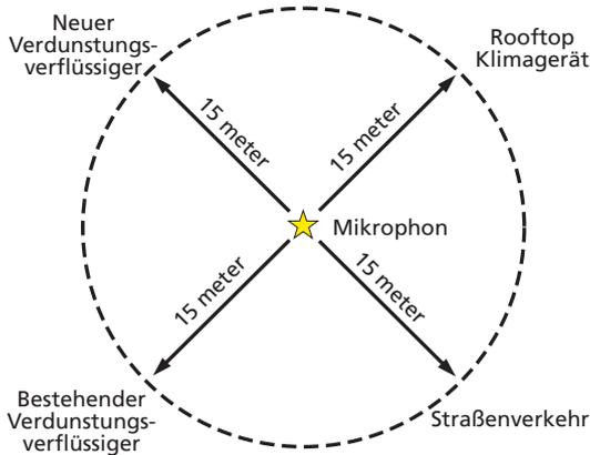
Falls der Schall in einem Abstand von 15 m oder mehr von der schallempfindlichen Stelle festgelegt wird, werden die gemessenen Daten zunehmend ungenauer, da die Wahrscheinlichkeit steigt, dass sich innerhalb dieses Radius von 15 m um das Schallmessmikrophon auch noch andere Schallquellen befinden.
