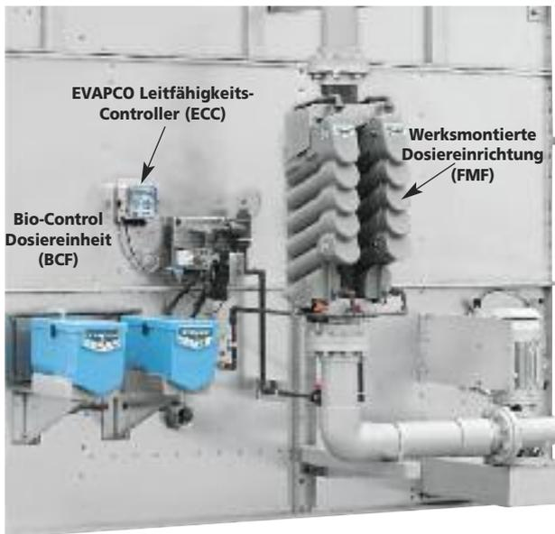
EVAPCO's **Smart Shield®** System verwendet Feststoffchemikalien, die über ein einzigartiges Dosiersystem zugeführt werden. Kalk- und Korrosionsinhibitoren werden mithilfe eines patentierten Systems mit kontrollierter Freisetzung (Controlled Release) zugeführt, sobald die Sprühwasserpumpe in Betrieb ist, um Ihr System während dieser Betriebsdauer zu schützen. **Smart Shield®** ist ein komplettes Wasseraufbereitungs-Paket und bietet:
