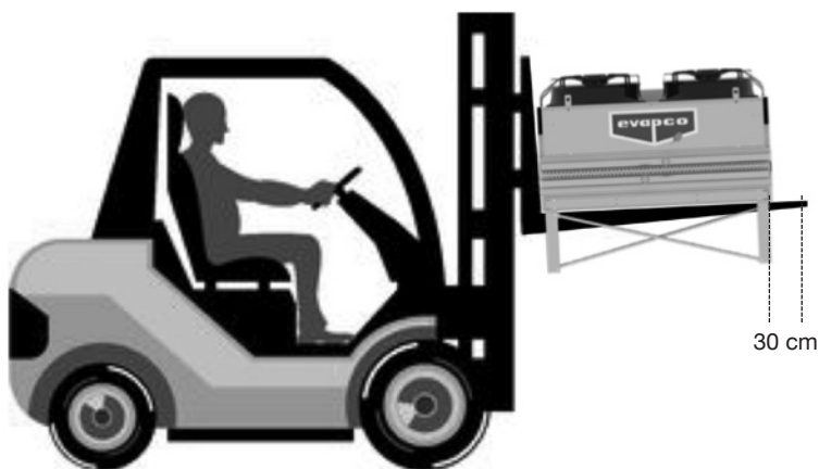
Rysunek 4 – Wymagania dotyczące podnoszenia wózkiem widłowym jednostek z płaską węzownicą
