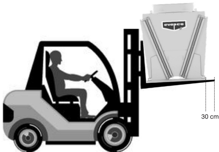
Rysunek 12 – Wymogi dotyczące podnoszenia wózka widłowego z modulem V coil
